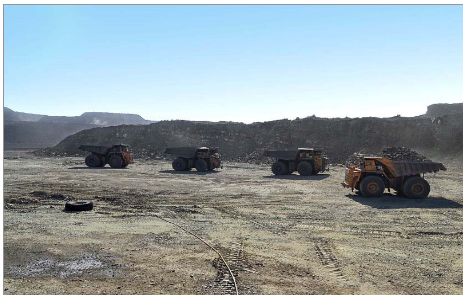
Вскрышные работы на разрезе «Нерюнгринский». Вывоз породы. 1978 г.
